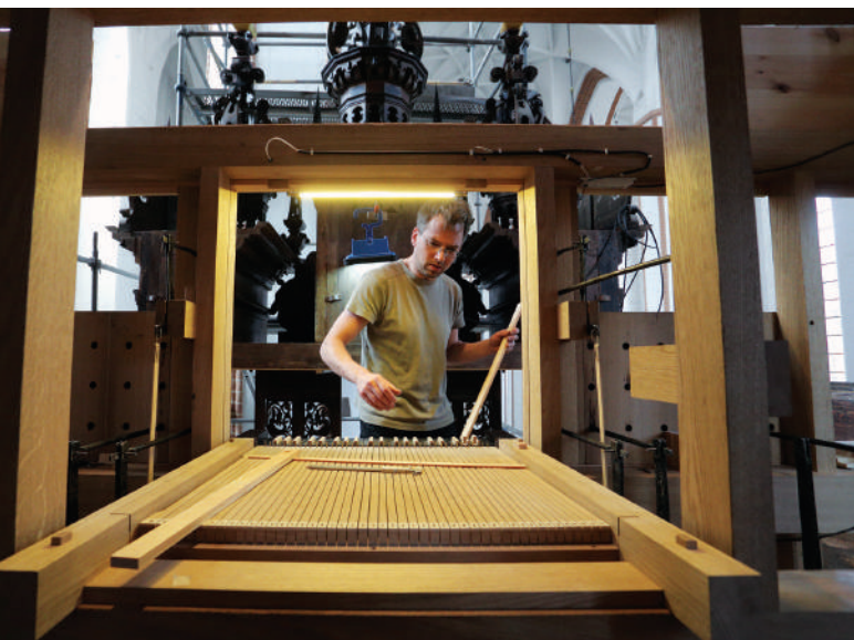
Montaż i intonacja pierwszych 12 głosów organowych
